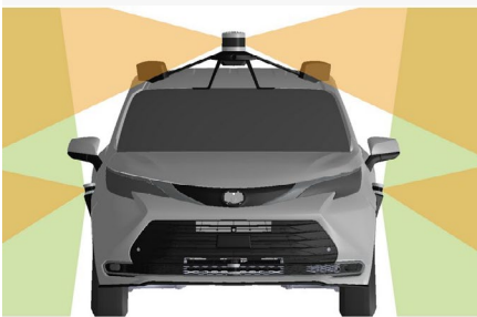
SIDE LIDAR & CAMERA, TOP LIDAR
